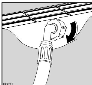
Ни в коем случае не используйте уже бывшие в употреблении наливные шланги. Другой конец наливного шланга, подключающийся к машине, может быть повернут в любом направлении. Ослабьте гайку, поверните шланг и вновь затяните гайку, проверив отсутствие течей воды. Наливной
