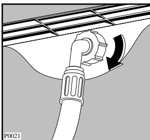
Vattenanslutningen kopplas till kallvatten. För vattenanslutning får endast den tilloppssläng som medföljer maskinen användas. Använd inte en gammal, begagnad slang.
