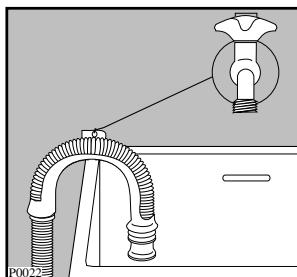
**Suoraan tyhjennysputkeen:** on hyvä käyttää 65 cm korkeaa putkea. Putki ei missään tapauksessa saa olla lyhyempi kuin 60 cm eikä pitempi kuin 90 cm.
