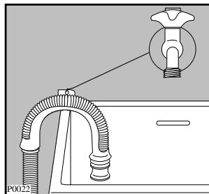
**Anslutning till golvbrunn:** Fäst ett rör på väggen, 60-80 cm från golvet och anslut avloppsslängen till röret. Avloppsslängens ändstycke skall vara ventilerat, d.v.s. rörets invändiga diameter skall vara min. 40 mm. Se till att slängen sitter fast och inte kan lossna.
