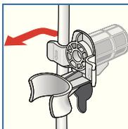
4. Извлеките сетевую кабель из креплений. Снимите втулки.
