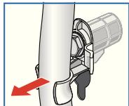
2. Извлеките шланги из колен для фиксации и снимите колена.
