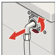
Снимите шланг со спинки прибора.
