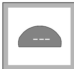
Если селектор программ находится в положении **O**, то на дисплее появятся три мигающих линии. При других положениях селектора на дисплее появится длительность соответствующей программы.
