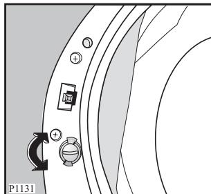
Для отключения этого устройства, чтобы снова можно было закрыть дверцу, поверните кнопку против часовой стрелки так, чтобы паз оказался в вертикальном положении.
