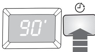
**Перед тем, как запустить программу**, если Вы хотите задать отсрочку пуска, нажимайте кнопку “Отсрочка пуска” до тех пор, пока на дисплее не высветится нужное время задержки. Значение выбранной отсрочки (максимум 20 часов) будет высвечиваться на дисплее в течение примерно 3 секунд, после чего на нем снова появится продолжительность выбранной программы.
