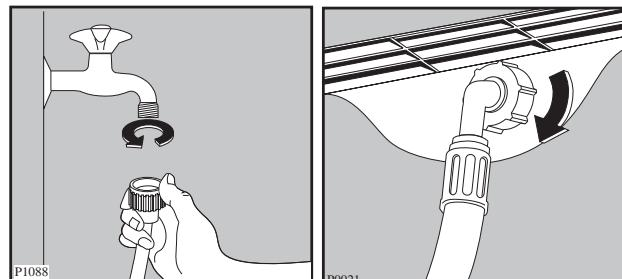
Другой конец наливного шланга, подключающийся к машине, может быть повернут в любом направлении. Ослабьте гайку, поверните шланг и вновь затяните гайку, проверив отсутствие течи воды. Наливной шланг нельзя вытягивать. Если он слишком короткий, и вы не хотите передвигать кран, то вам следует купить новый, более длинный шланг, специально предназначенный для данных целей.
