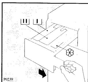
Программная карточка установлена внутри дозатора.
