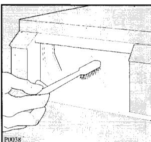
Моющее средство может также отложиться и в нише дозатора, которую следует время от времени прочищать старой зубной щёткой. После выполнения чистки установите дозатор на место и выполните цикл полоскания без белья.
