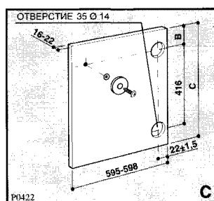
Для установки петель не обходится вы сверлить на внутренней стороне двери два углубления (диаметр 35 мм, глубина 14 мм). Расстояние между углублениями должно составлять 416 мм.
