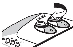
Если вы решили изменить программу во время работы машины, отключите кнопку **ПУСК/СТОП**, а после изменения программы вновь нажмите кнопку **ПУСК/СТОП**.
