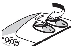
Если вы решили изменить программу во время работы машины, отключите кнопку **ПУСК/СТОП**, а после изменения программы вновь нажмите кнопку **ПУСК/СТОП**.
