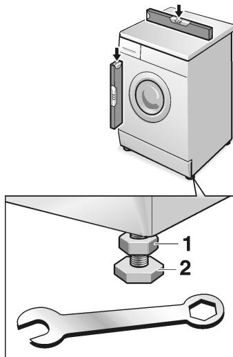
Машину следует выровнять со всех сторон с помощью регулируемых по высоте ножек и ватерпаса.
