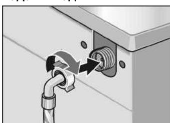
к элементу подключения с обратной стороны машины и...
