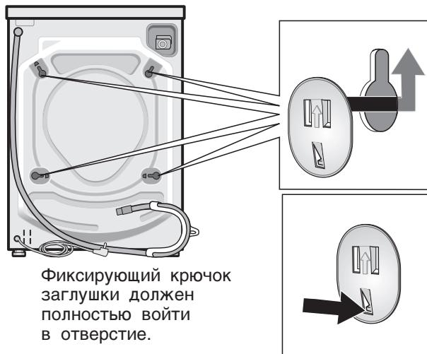
Фиксирующий крючок заглушки должен полностью войти в отверстие.
