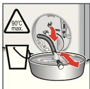
4. Снимите сливной шланг с держателя. Снимите крышку, слейте моющий раствор в соответствующую емкость. Установите закрывающую пробку на место. Вставьте сливной шланг в держатель.
