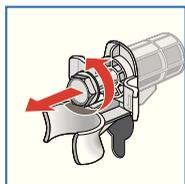
3. Отвинтите и снимите 4 транспортировочных фиксирующих винта.
