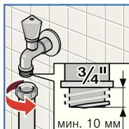
на водопроводном кране ( $\frac{3}{4}$ " = 26,4 мм):
