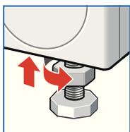
3. Затяните контргайку так, чтобы она была прижата к корпусу. Ножку при этом следует удерживать в зафиксированном положении, исключая возможность ее перемещения по высоте.
