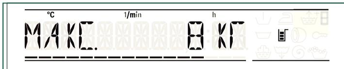
Участок дисплея показывает рекомендованную дозировку в зависимости от загруженного количества белья. Указание в % касается рекомендации изготовителя моющего средства.
